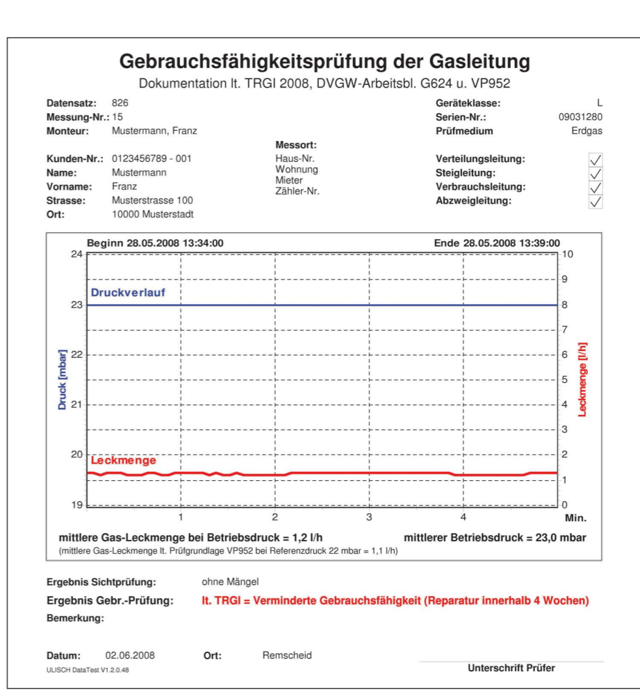
Abb. 4 · Gasleckmengenprüfung-TRGI2008.
