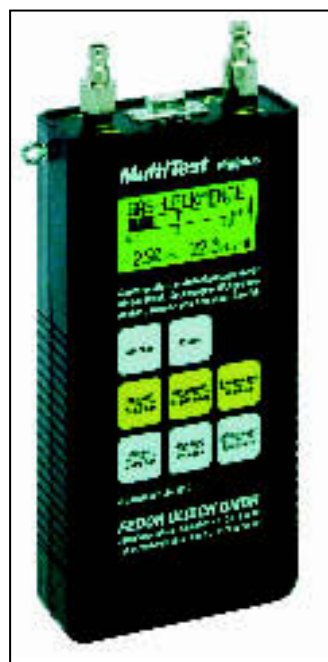
■ Leckmengenmessgerät der Klasse L (DVGW-zertifiziert gemäß VP952). Digitales Mess- und Aufzeichnungsgerät für Gas-Druck, -Leckmenge und -Dichtprüfungen im Gas-, Wasser- und Abwasser-Bereich mit manipulations-sicherer Abspeicherung von bis zu 100 Messungen mit variablen Messzeiten von 5 Minuten bis 7 Tagen.
