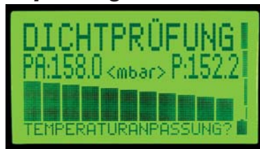
Messbereich 0-300 mbar für Dichtprüfungen nach TRGI 2008 (Wassersäule als Balken-Diagramm)
