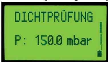
Messbereich 0-300 mbar für Dichtprüfungen nach TRGI 2008 (Wassersäule als Balken-Diagramm)
