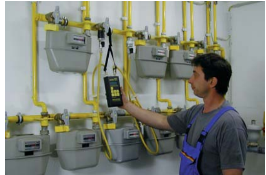
Das Gerät arbeitet mit einem Durchfluß-Sensor wie ein Feingaszähler, nur die tatsächlich nachströmende Gasmenge = Leckrate wird gezählt.
