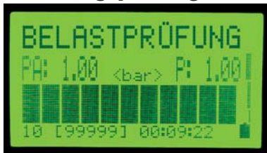
Messbereich 0-1,5 bar bzw. 0-25 bar, Anzeige des anliegenden Druckes und der Messzeit
