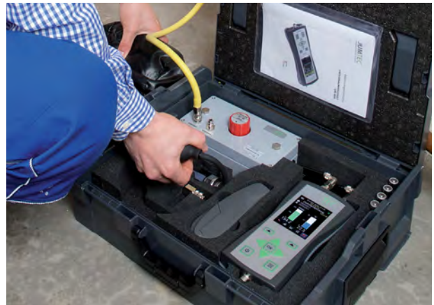
Leckmengenmessung mit Zähler mit externer Gasversorgung GV-100
