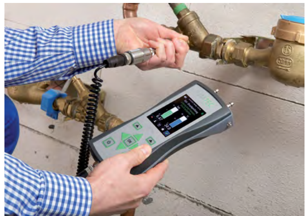
Einsatz mit Hochdrucksensor bis 25bar
